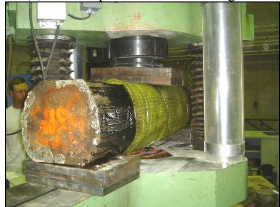
(d) Repair method B – bending
