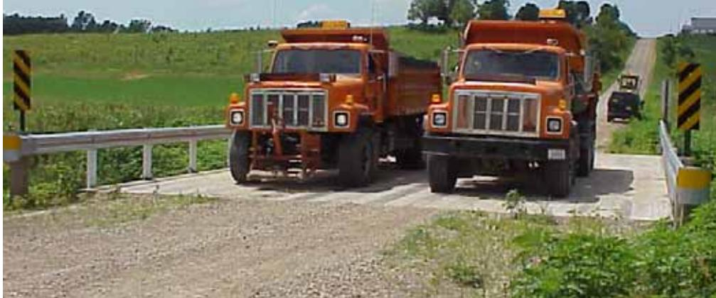
a. Static load test
