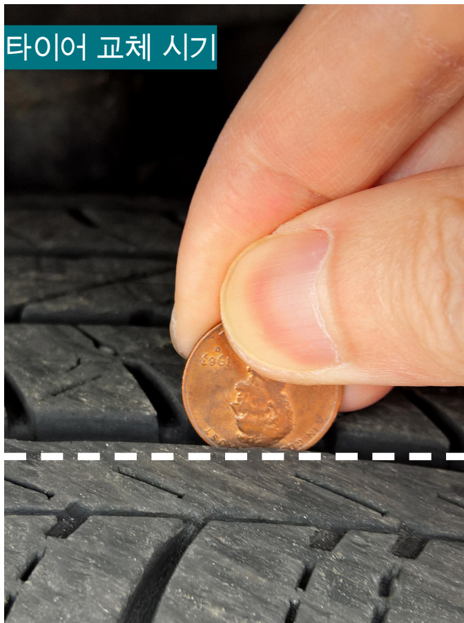
그림 3.1: 1페니를 이용해 타이어 트레드를 점검하십시오
